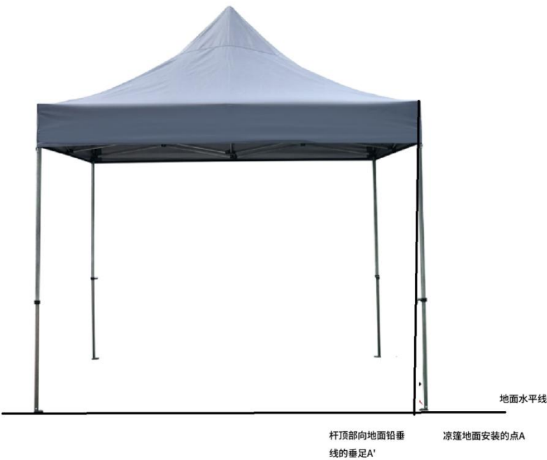
图5 骨架弯曲度测试示意图
