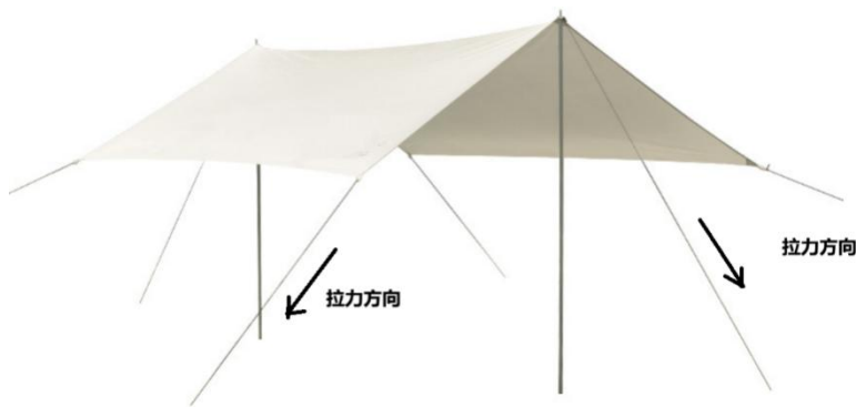
图2 防风绳拉力测试
