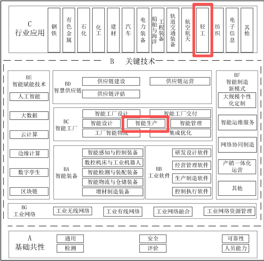
图1. 智能制造标准体系结构图
